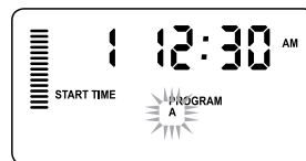
Ejemplo de pantalla parpadeante mientras se mantiene pulsado el botón PRG
