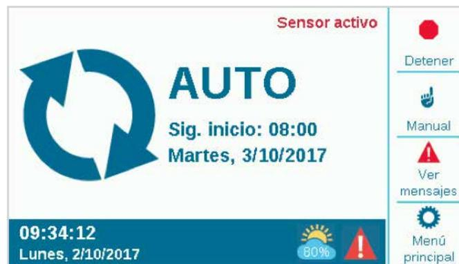
Si Solar Sync está instalado y activado (menú Dispositivos), el símbolo Solar Sync muestra el porcentaje de ajuste actual en la parte inferior derecha del borde.
