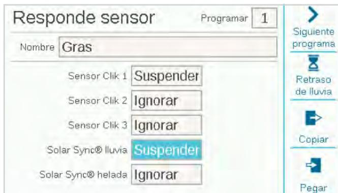
Hay tres entradas estándar de sensores Klik en el tablero de alimentación. Si se configuró un sensor Solar Sync de Hunter, también hay configuraciones para Solar Sync lluvia y helada.
